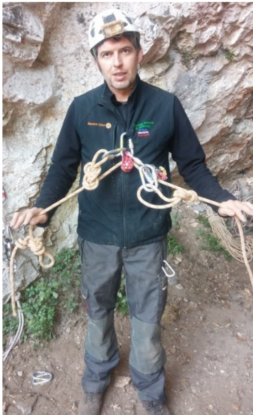
Poulie-bloqueur verrouillé dans les règles de l'art.
